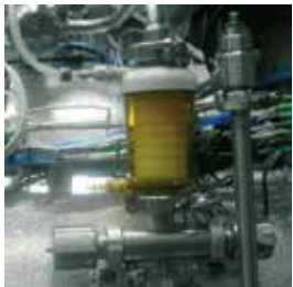
Decontamination of exhaust air with sterile filter / Decontaminazione dell'aria di scarico con filtro sterile
